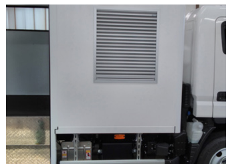
Belüftungsmöglichkeit für feuchte Geräte Räume
